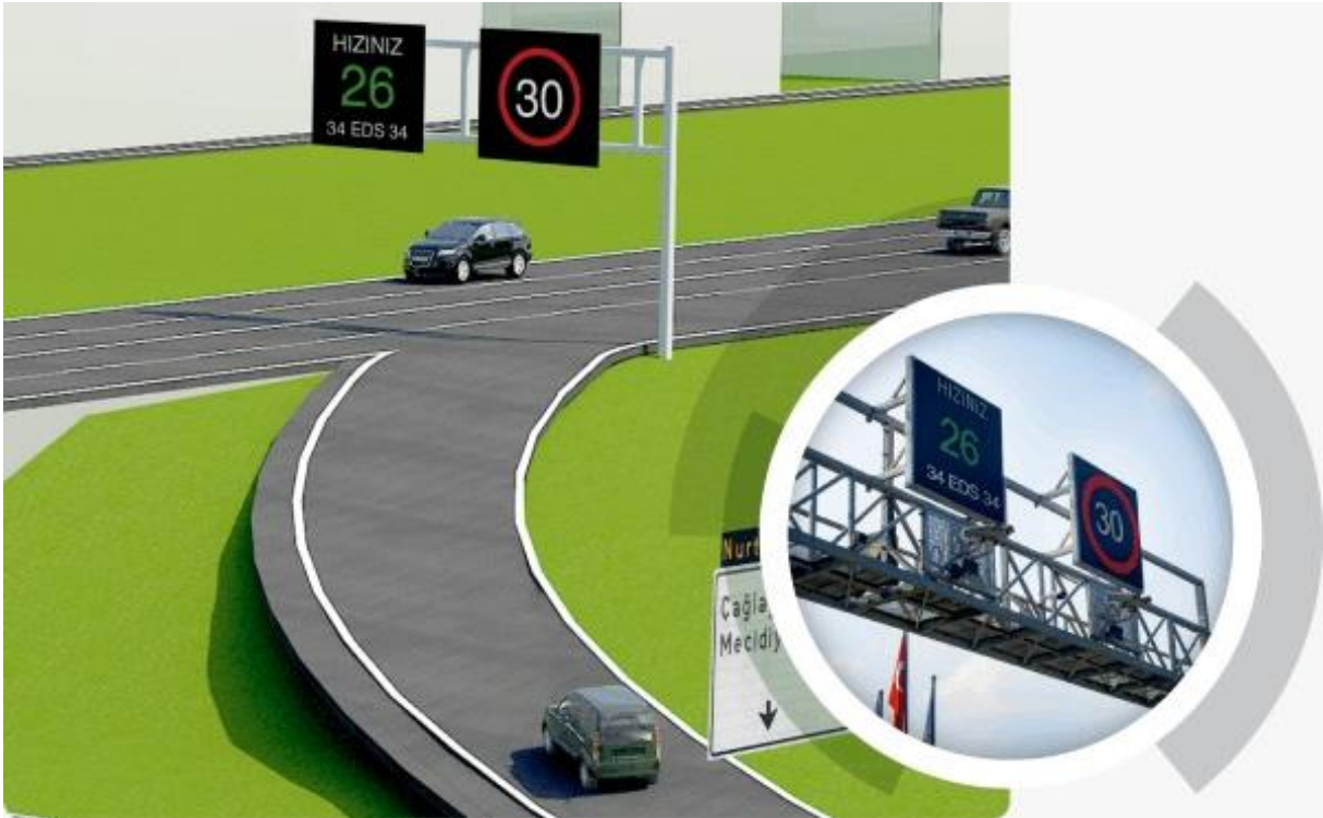
Şekil 12. Anlık Hız Elektronik Denetleme Sistemi [31]
